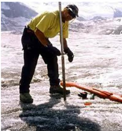
Setzen einer Messstange auf der Gletscherzunge.
